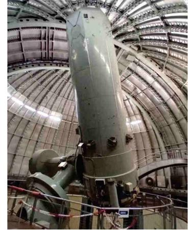
Dès 1932 un premier télescope est installé à St Michel pour tester le site. Les essais sont concluants et en 1936 décision est prise d'y installer un observatoire. Le télescope préalablement utilisé pour les essais (équipé d'un miroir primaire de 80 cm) y est installé en 1945 mais il est à pointage manuel, l'assistance informatique n'étant pas encore développée (ce télescope est encore fonctionnel).
